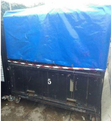
Cesta con pareti piene e telo sagomato, idrorepellente e occhiellato, e pareti con anelli per la sigillatura.
